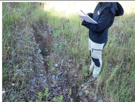
Illustration 41 : Phénomène de ravinement sur une banquette du site
